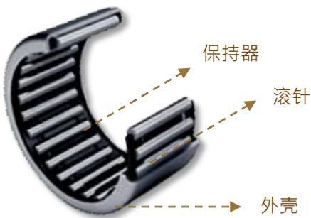
滾針軸承相對於滾珠軸承具有較小的截面積與體積，却有更好的負重能力，故適用於體積小的精密構件中。因為滾針軸承輕、小的特性，能有效降低運作中，所受的扭力及慣性力，進而提升機械效率。滾針軸承的受力方式為線接觸，因此更適於應用在震動或搖動的運作環境。
